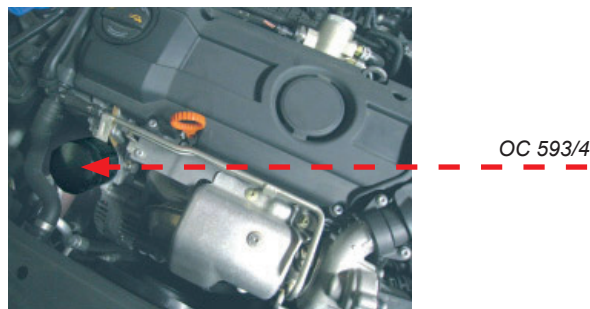
Figure 1 : position de montage : vue de dessus du moteur
