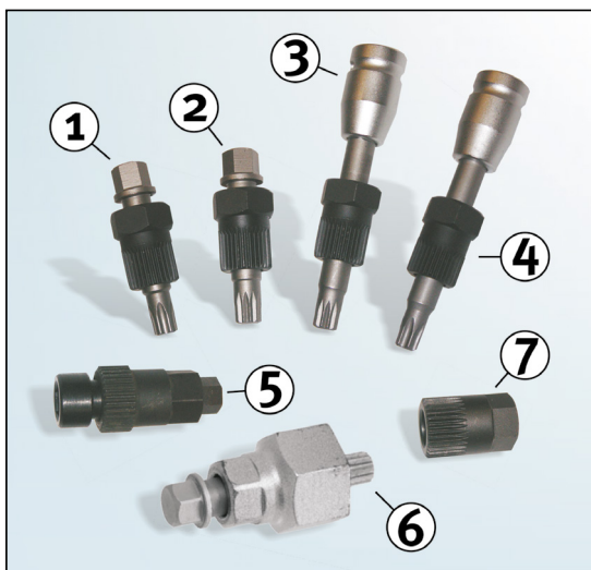
Figur 5: Spesialverktøy til montering og demontering av ulike friløprensiver OAP
