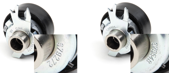
Foto 2: po lewej – rolka napinacza 531 0252 30, po prawej – rolka napinacza 531 0525 30
