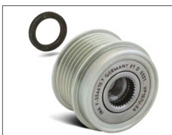
Foto 2: Podczas montażu wolnego koła na alternatorze Visteon (Ford Mondeo III) należy zastosować dołączoną podkładkę dystansową o grubości 3 mm.
