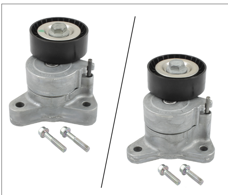
Foto 1: Ramię napinacza 534 0325 10 – po lewej, stara wersja ze śrubami mocującymi. Po prawej nowa wersja ze śrubami mocującymi.
