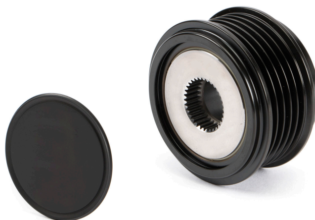
Zdjęcie 2: 535 0071 30 – nowa konstrukcja z pokrywą ochronną
