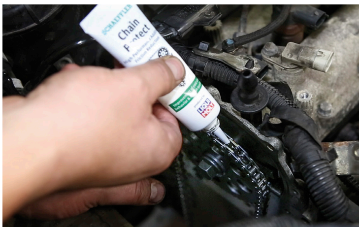
Zdjęcie 2: Schaeffler Chain Protect stosuje się do wszystkich elementów łańcuchowego układu napędu rozrządu, podczas montażu łańcucha
