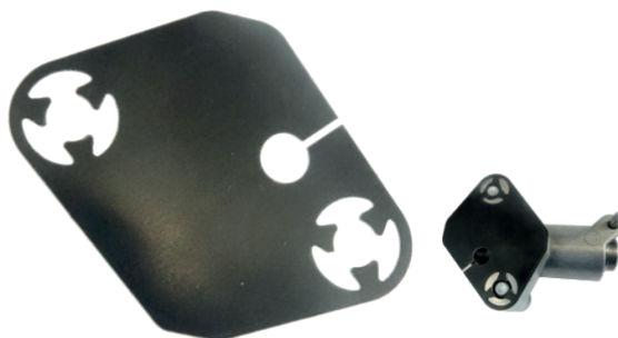
Rysunek 2: Uszczelka między blokiem silnika a napinaczem łańcucha
