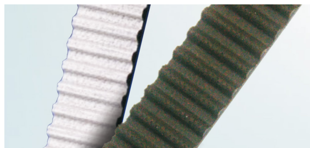
Figur 2: Sort og hvitt belegg på tannprofilen
