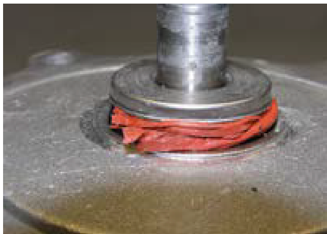
Foto 1: Pasta silikonowa wkręcona w uszczelnienie pompy płynu chłodzącego
