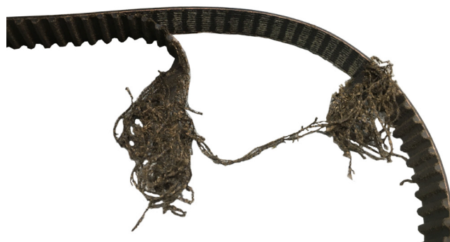
Foto 1: Pasek rozrządu z uszkodzonymi zębami
