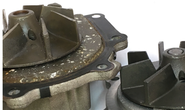
Foto 1: Przemieszczony wirnik z podcięciem (z lewej); prawidłowe położenie wirnika (z prawej)
