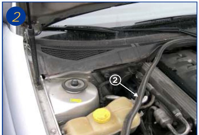
Retirer sur la moitié le joint d'étanchéité du compartiment moteur (flèche 2).
