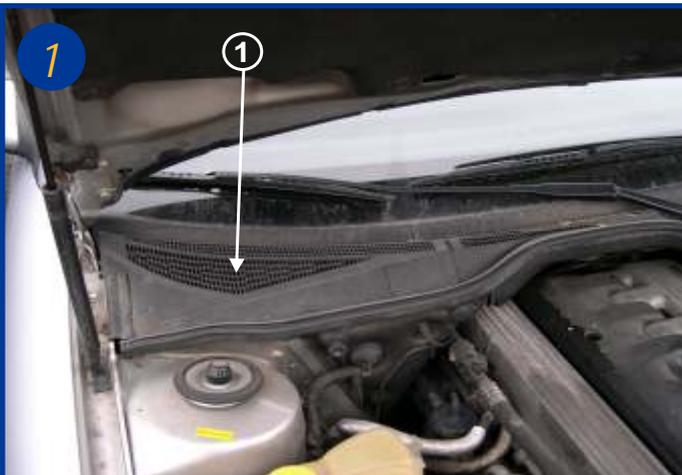
L'élément filtrant est situé dans le boîtier d'aération sous le capot moteur coté passager (voir flèche 1). Ouvrir le capot moteur.
