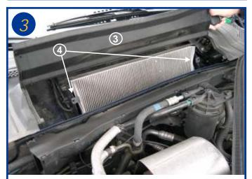
Soulever le volet en matière plastique (3). Ouvrir les clips en plastique situés sur le boitier du filtre et retirer l'élément filtrant usagé (flèche 4).
