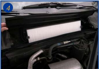
Placer le nouvel élément filtrant dans le boitier. Le remontage s'effectue dans l'ordre inverse du démontage.
