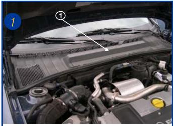
L'élément filtrant est situé au centre sous le capot moteur (flèche 1).
