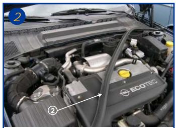
Retirer sur la moitié le joint d'étanchéité du compartiment moteur (voir flèche 2).
