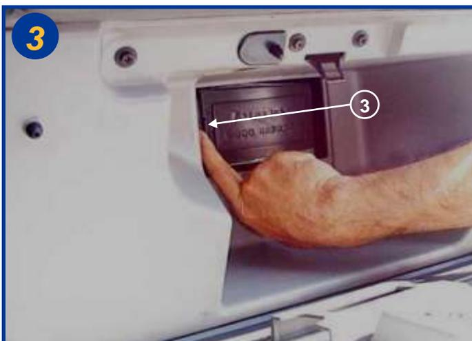
Ouvrir le boîtier filtrant à l'aide du loquet de fermeture situé sur la gauche (3).
