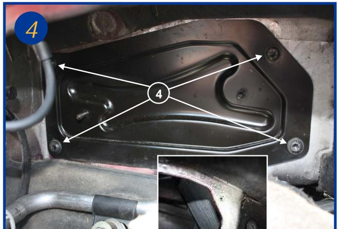
Ensuite, le démontage est identique pour les 2 cotés, dévisser les 4 vis T30 qui fixe la plaque métallique (4). Extraire le filtre (voir encadré). Répéter la même opération sur le coté gauche. Le remontage s'effectue dans l'ordre inverse du démontage.
