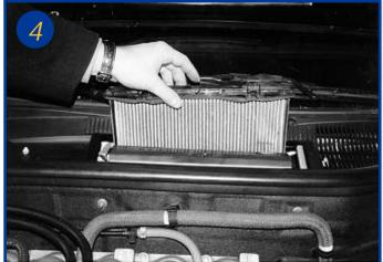
Tirer vers le haut l'élément filtrant usagé -Le remontage s'effectue dans l'ordre inverse du démontage
