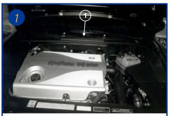
L'élément filtrant est situé sous le capot moteur sous la baie du pare brise au centre (1).
