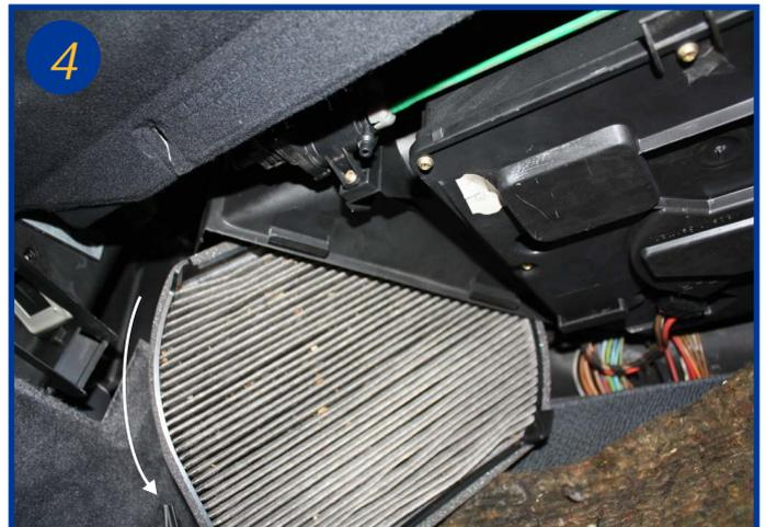
Extraire l'élément filtrant usagé vers le bas dans un mouvement légèrement circulaire.
