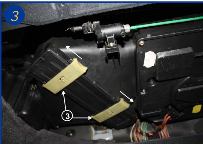
Repousser vers l'extérieur (dans le sens des flèches) les 2 coulisses (3) du couvercle du boîtier filtrant et le retirer.
