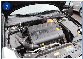
Le filtre d'habitacle est situé sous le capot moteur, coté passager sous la baie de pare-brise (1). Ouvrir le capot moteur.
