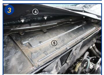
Dégrafer le carter de la baie de pare-brise et le maintenir soulevé, il n'est pas nécessaire de le démonter (4).
