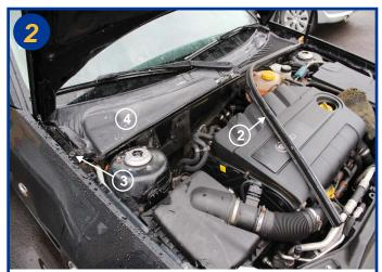
Retirer sur la moitié le joint d'étanchéité du capot moteur (2). Retirer le clips plastique (3).
