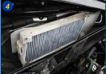
Ouvrir les 2 volets de fermeture (6), les soulever pour dégager l'élément filtrant usagé et le remplacer. Le remontage s'effectue dans l'ordre inverse du démontage.
