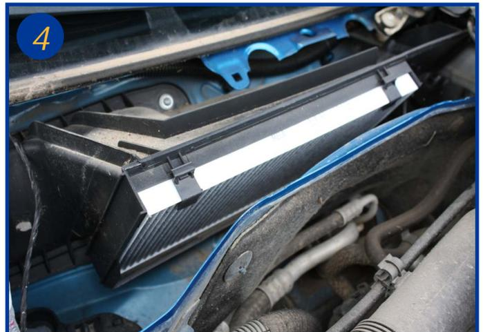
Replacer dans son logement un filtre neuf et basculer les 2 fermoirs. Le remontage s'effectue dans l'ordre inverse du démontage.
