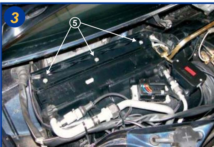
Dévisser les 3 vis de 5.5 sur le couvercle du boîtier filtrant (5) et retirer ce couvercle.
