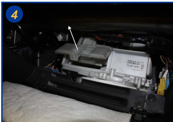
Retirer totalement la trappe d'ouverture en la soulevant (voir flèche).
