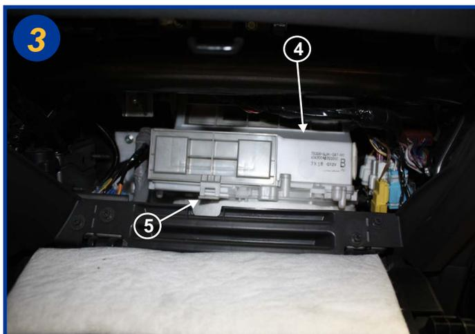
Pour ouvrir le boîtier (4), soulever la patte de fermeture (5) et soulever vers le haut la trappe d'ouverture.
