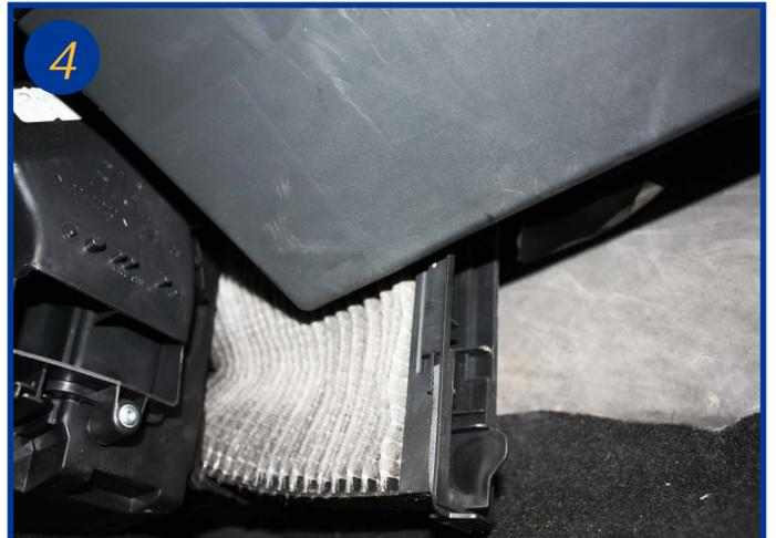
Sortir le filtre en le déformant. Procéder à son remplacement, le remontage s'effectue dans l'ordre inverse du démontage.
