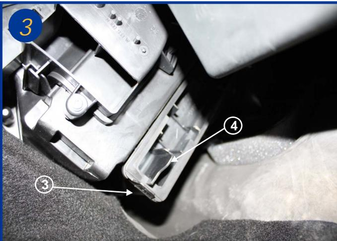
Pour extraire le filtre usagé, soulever à la base du couvercle (3) et tirer vers soi à l'aide de la poignée (4).
