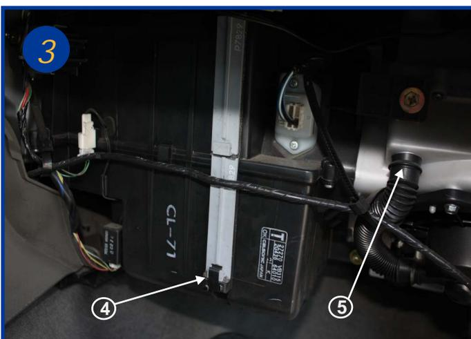
A l'aide d'un tournevis retirer l'agrafe métallique (4)
