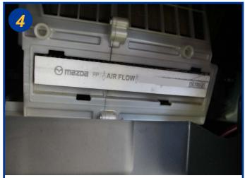
Extraire I 'élément filtrant usagé et le remplacer. Le remontage s 'effectue dans I 'ordre inverse du démontage.
