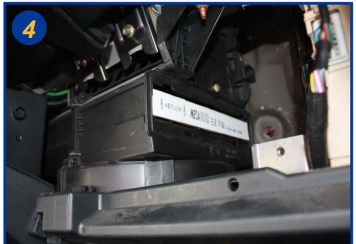
Extraire le filtre usagé en le glissant hors de son logement, il est nécessaire de le déformer. Procéder à son remplacement. Le remontage s'effectue dans l'ordre inverse du démontage.
