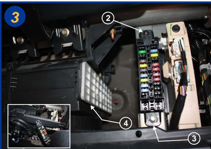
Dévisser la vis cruciforme (2), puis la vis hexagonale de 7mm (3), dégager le boîtier à fusible et l'écarter en le passant par l'intérieur (voir encadré). Ouvrir le boîtier filtrant (4).
