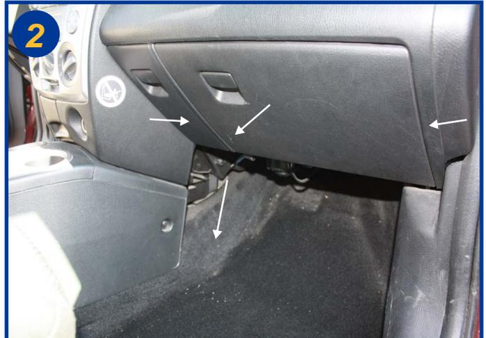
Ouvrir la boîte à gants, presser sur les flancs de celle-ci pour dégager les arrêtoirs et basculer l'ensemble vers le bas pour désolidariser le tiroir.
