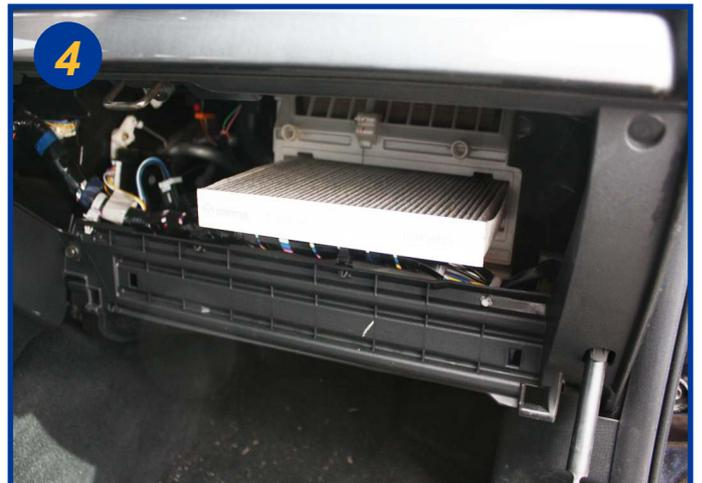
Extraire l'élément filtrant usagé et procéder à son remplacement. Le remontage s'effectue dans l'ordre inverse du démontage.
