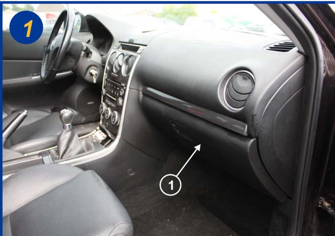
Le filtre d'habitacle est situé à l'intérieur du véhicule, côté passager, derrière la boîte à gants (1). Ouvrir la boîte à gants.
