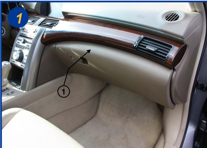
Le filtre d'habitacle est situé à l'intérieur du véhicule, côté passager dans la boîte à gants (1).
