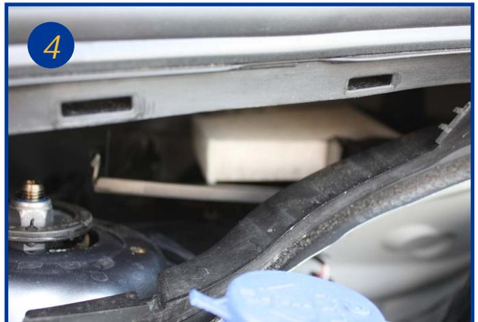
Puis retirer le second filtre au fond du boîtier, ils sont placés l'un à côté de l'autre, le deuxième étant plus petit. Le remontage s'effectue dans l'ordre inverse du démontage.
