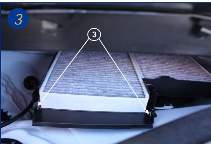
3 Basculer la trappe d'ouverture du boîtier en agissant sur les 2 loquets aux deux extrémités du couvercle (3).
