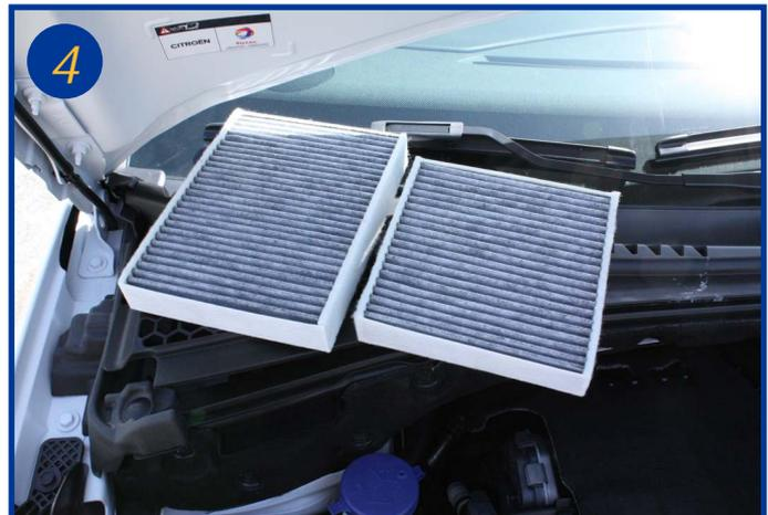
4 Extraire les deux filtres usagés en les faisant coulisser hors du boîtier. Le remontage s'effectue dans l'ordre inverse du démontage.
