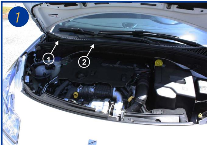
1 Les filtres d'habitacle sont situés sous le capot moteur, coté passager sous la baie de pare-brise (1). Retirer sur une bonne moitié le joint d'étanchéité du compartiment moteur (2).
