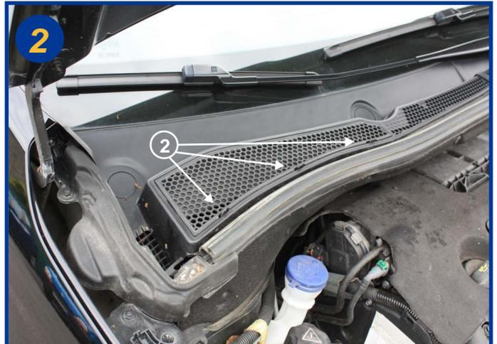
Retirer la grille de ventilation en actionnant les loquets de fermeture (2). Déposer la grille.
