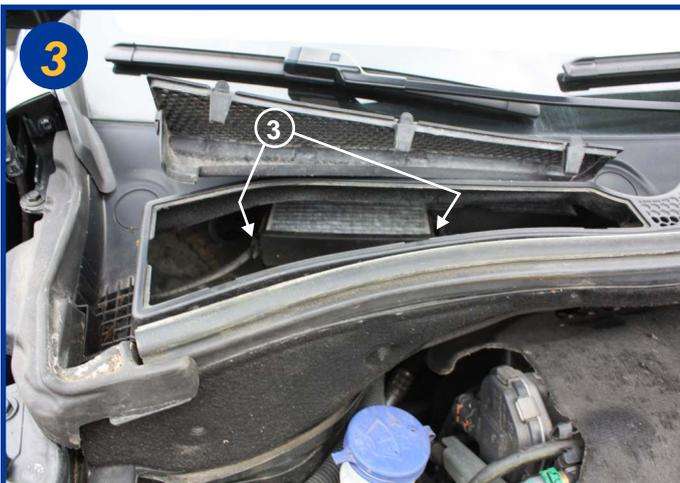
Ouvrir la trappe de fermeture en actionnant les fermoirs situés de part et d'autre de celle-ci (3) et la basculer vers le bas. Retirer les éléments filtrants usagés.
