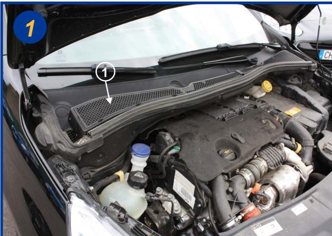
Les filtres d'habitacle est situé sous le capot moteur, du côté passager devant la baie de pare-brise (1). Ouvrir le capot moteur.
