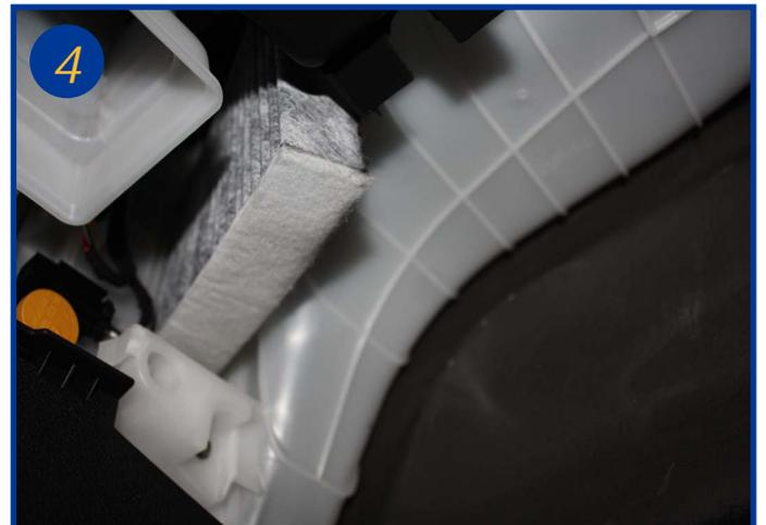
Extraire les 2 éléments filtrants usagés, placés l'un au dessus de l'autre à l'aide des languettes prévues.
