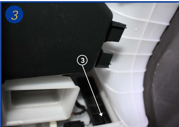
Accéder au boîtier filtrant par dessous et retirer son couvercle en se servant de la poignée (3).
