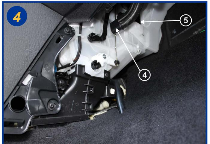
Débrancher la durite souple de ventilation (4) pour avoir un accès plus aisé au couvercle du boîtier filtrant (5).
