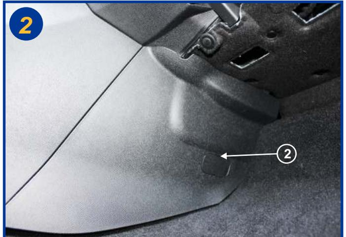
Démonter le flanc de console, pour cela retirer le cache plastique (2) à l'aide d'un tournevis plat et dévisser la vis torx (T25) puis tirer fortement pour dégrafer le carter.
