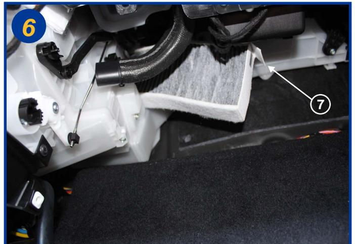
Retirer le premier élément en tirant sur la languette fixée sur le filtre et prévue pour cela (7).
