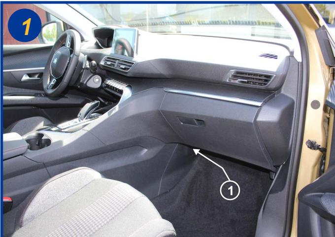
Les filtres sont situés à l'intérieur du véhicule, côté passager sous la boîte à gants côté console centrale (1).
