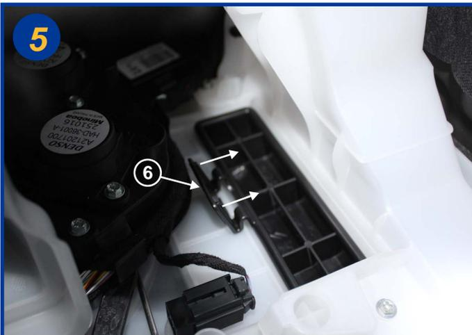
Pour ouvrir le boîtier filtrant agir sur la poignée (6) dans le sens de la flèche et retirer le couvercle.
