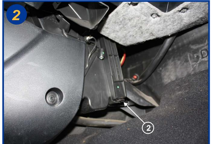
Sous la boîte à gants, ouvrir le boîtier filtrant à l'aide de la patte de fermeture (2). Retirer le couvercle.
