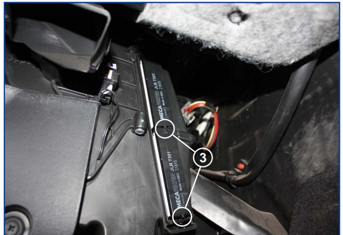
Replacer des filtres neufs en respectant le guidage (3). Une fois le résultat ci-dessus obtenu, remplacer le couvercle du boîtier en pressant jusqu'à l'obtention du clic.
