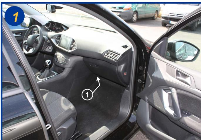
Les filtres d'habitacle au nombre de 2 sont accessibles à l'intérieur du véhicule, côté passager, sous la boîte à gants côté console centrale (1).
