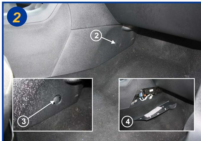
Retirer l'opercule plastique (2) puis derrière le clips (3)
