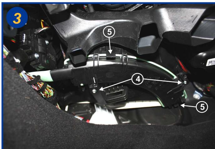
Dévisser les 2 vis torx T15 (4), puis écarter les pattes de maintien (5) pour extraire le couvercle du boîtier filtrant.
