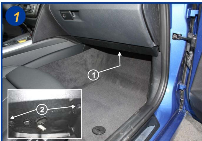
Le filtre d'habitacle est situé à l'intérieur du véhicule, sous la boîte à gants côté passager (1). Dévisser les 2 vis de 10 sous la boîte à gants (2) (voir encadré).
