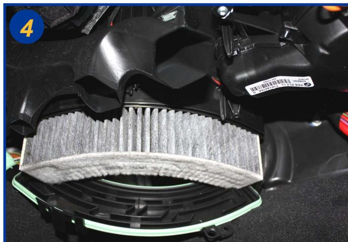
Sortir le filtre usagé et procéder à son remplacement. Le remontage s'effectue dans l'ordre inverse du démontage.
