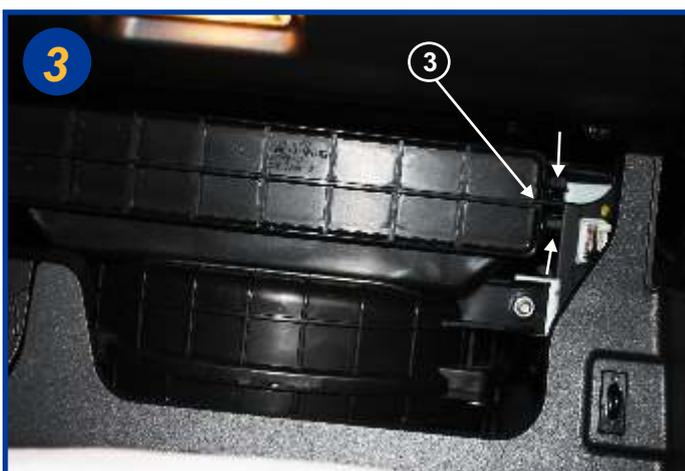
Appuyer sur les 2 pattes du fermoir (3) dans le sens des flèches pour ouvrir le boîtier filtrant. Extraire le couvercle, celui-ci ne possède qu'une fermeture à droite.
