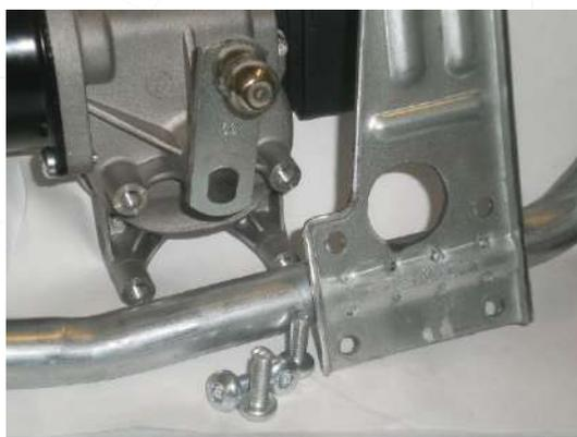
Nel dettaglio è visibile uno dei quattro fori nel nuovo motorino OE privo della filettatura. I fori non sono filettati in quanto le viti previste sono autofilettanti.
