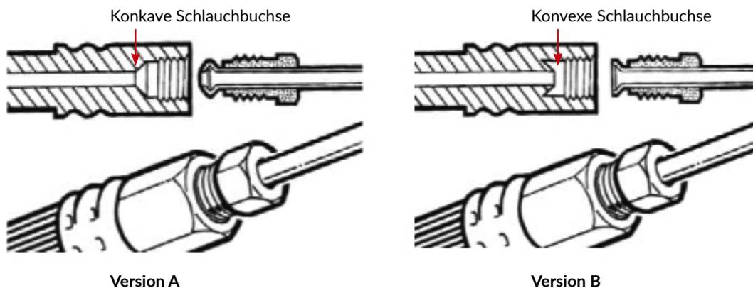
**Version A** - Konkave Verbinderbuchse, zum Aufnehmen eines konvexen Rohrflansches
