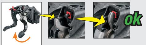
se vollkommen herausziehen, auf die Befestigungslamellen drücken und den zu ersetzen-Schalter entfernen.
