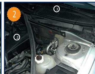
Retirer sur la moitié le joint d'étanchéité du compartiment moteur (2) pour dégager le couvercle de la grille d'aération. Retirer cette grille en dégageant les 2 clips (flèche 3).
