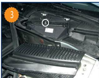
Retirer le couvercle du climatiseur maintenue par 2 vis (4).
