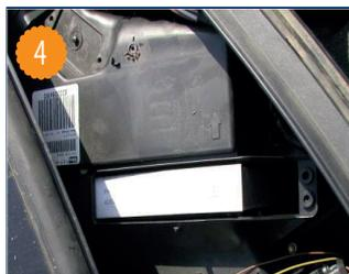
Extraire l'élément filtrant en le tirant vers le haut. Remplacer l'élément filtrant usagé par un nouvel élément. Le remontage s'effectue dans l'ordre inverse du démontage.
