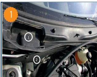
L'élément filtrant est situé sous la baie de pare brise coté passager. Ouvrir le capot moteur. Retirer la trappe sur la grille d'aération (1) et le joint d'étanchéité du compartiment moteur sur la moitié (2). Retirer également l'essuie-glace après avoir dévissé l'écrou hexagonal
