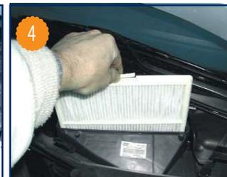
Extraire l'élément filtrant usagé en le tirant vers soi. Engager le nouvel élément dans les glissières. Le remontage s'effectue dans l'ordre inverse du démontage.
