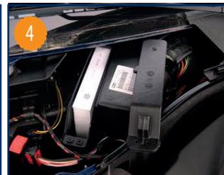
Extraire l'élément filtrant usagé, le remplacer. Le remontage s'effectue dans l'ordre inverse du démontage.
