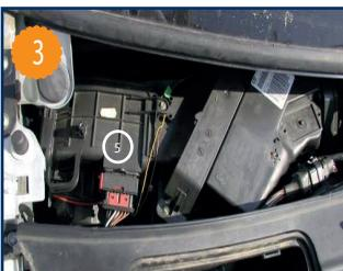
Dévisser ensuite le couvercle du boîtier du filtre sur le climatiseur (flèche 5).
