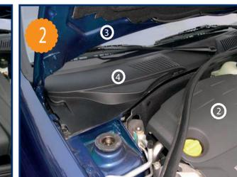
Retirer sur la moitié de sa longueur, le joint d'étanchéité du compartiment moteur (flèche 2). Déclipser le cache en matière plastique (flèche 3) Retirer le cache (4).
