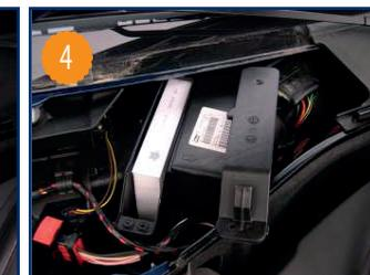
Extraire l'élément filtrant usagé, le remplacer. Le remontage s'effectue dans l'ordre inverse du démontage.
