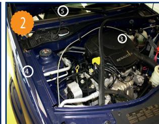
Retirer le joint d'étanchéité du compartiment moteur (3), puis le rivet plastique (4) pour extraire le cache grillagé (5) sur la moitié
