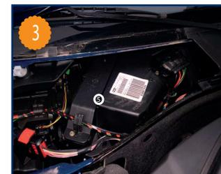
Dévisser le couvercle plastique, pour cela retirer le cable de son support et enlever la vis de maintien (voir flèche 5).
