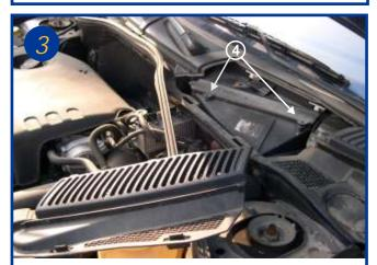
Défaire les vis Torx sur le boitier du filtre (flèche 4). Pour cela il faut utiliser un tournevis avec empreinte n°20. Soulever le couvercle en plastique sur le coté gauche (languette) et l'enlever.
