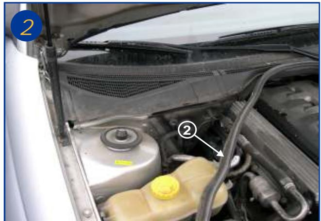
Retirer sur la moitié le joint d'étanchéité du compartiment moteur (flèche 2).
