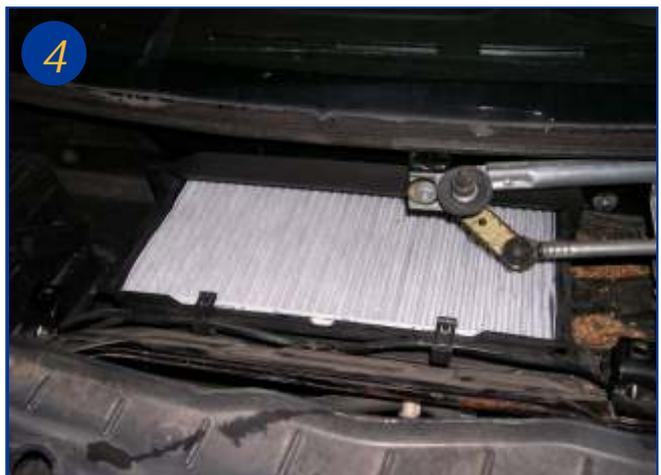
Installer le nouvel élément en veillant à positionner le joint mousse vers le bas. Faire glisser l'élément jusqu'au fond de son logement en compressant légèrement le joint et le faire basculer pour l'encliquer correctement.
