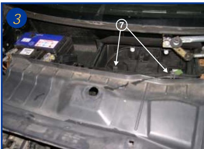
Basculer les 2 clips plastiques sur le boîtier du filtre (flèche 7).
