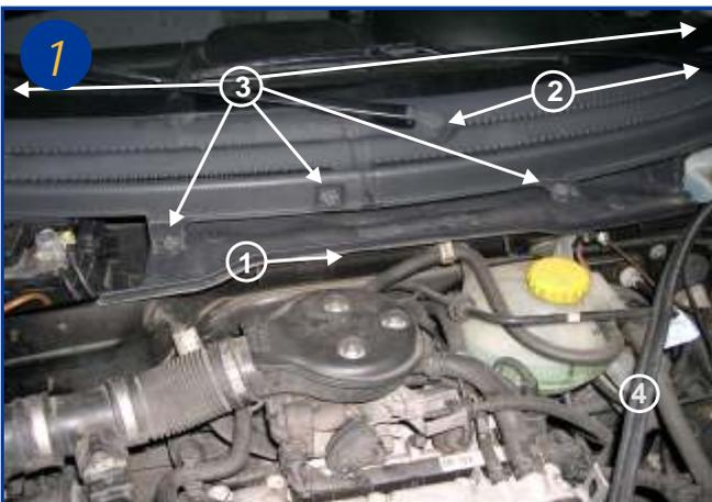
L'élément filtrant est situé sous le capot moteur au centre. (Flèche 1). Retirer les essuies-glace après avoir dévissé les écrous hexagonaux(2). Desserrer les 5 vis de la grille d'aération et la retirer (flèche 3)
