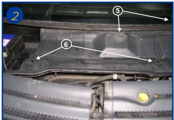
Retirer les 2 écrous hexagonaux plastiques et rondelles d'appui des axes de bras d'essuie-glaces (voir flèche 5)
