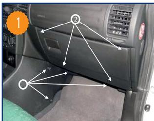
L'élément filtrant est situé derrière la boîte à gants.
