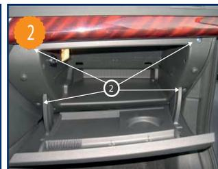
Ouvrir la boîte à gants, dévisser les quatre vis cruciformes fixant celle-ci (voir flèche 2) puis la retirer. Veiller à débrancher les 2 cosses électriques d'alimentation de l'éclairage de la boîte à gants.
