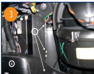
Ouvrir le boîtier filtrant après avoir retiré les 3 clips de fermeture (voir flèche 5).
