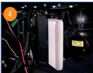
Extraire l'élément filtrant usagé, placer le nouvel élément filtrant dans ces rainures en évitant d'abîmer le joint en mousse autour de l'élément. Le remontage s'effectue alors dans l'ordre inverse du démontage
