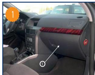
Le filtre L'élément filtrant est situé dans l'habitacle du véhicule coté passager derrière la boîte à gants. (Flèche 1).
