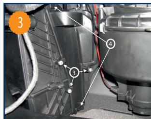
Dévisser ensuite les 3 vis fixant le couvercle du boîtier du filtre d'habitacle (flèche 3), retirer ce couvercle en faisant pression sur les pattes d'encliquetage situées aux deux extrémités de celui-ci (flèche 4).
