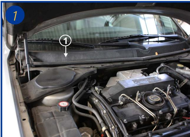
L'élément filtrant est situé sous le capot moteur, côté passager près de la baie de pare-brise (1).
