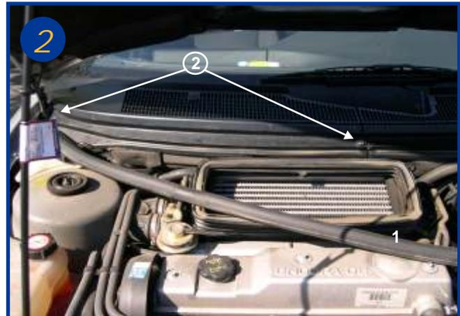
Oter le joint d'étanchéité entre le compartiment moteur et le conduit d'aération (1). Dévisser les 2 vis torx situées sur la demi-grille droite (2). Pour ces opérations, il vous est nécessaire d'utiliser un tournevis torx type n°30.
