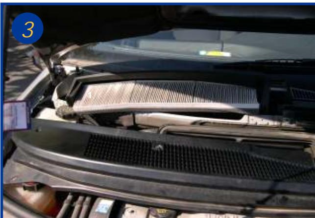
Ecarter au centre les 2 moitiés de la grille d'aération. Retirer la moitié droite de cette grille. Faire basculer les 2 pattes d'encliquetage (coté droit et coté gauche) sur le cadre porte-filtre. Dégager par le haut le cadre porte-filtre afin de retirer l'élément filtrant usagé.
