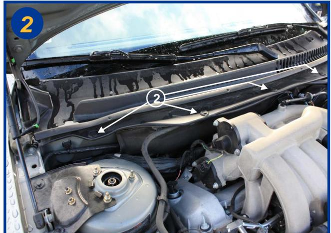
Retirer les 4 clips plastiques (2), à l'aide d'un tournevis plat soulever la partie centrale de chaque clips et les sortir.
