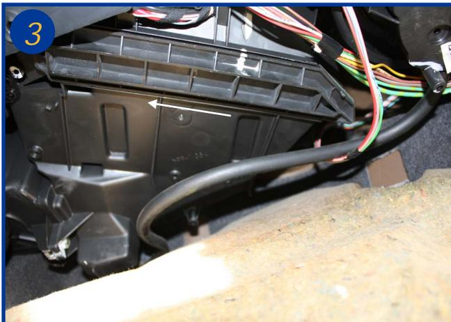
Faire coulisser le couvercle du boîtier filtre dans le sens de la flèche et le retirer.
