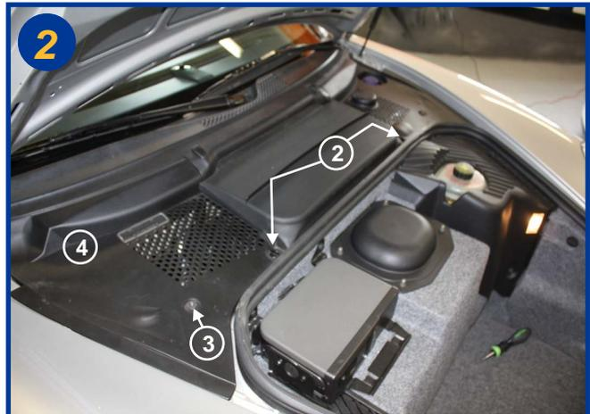
Démonter le carter cache batterie en actionnant d'un quart de tour les 2 vis plastique (2).
