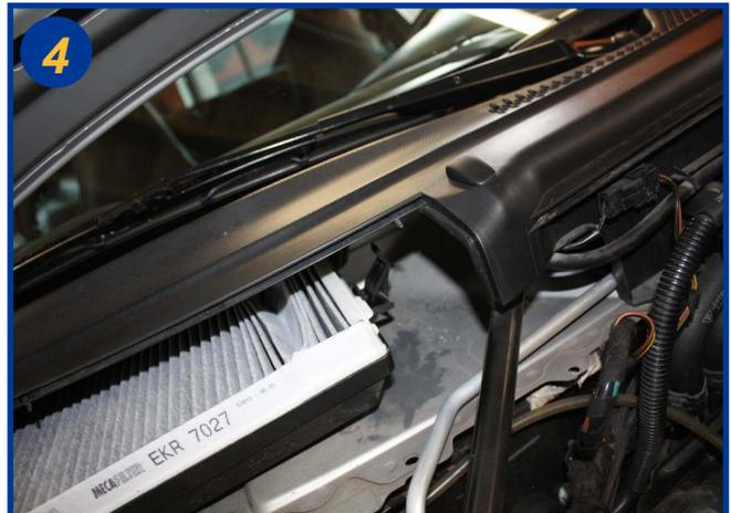
Remplacer un élément neuf et re-basculer le loquet pour verrouiller le filtre en place.
