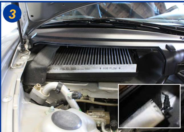
Basculer le loquet de maintien du filtre (voir encadré) et extraire l'élément filtrant usagé.
